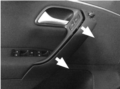
Lösen Sie die darunter befindlichen Torx-Schrauben sowie die Torxschrauben an der unteren Türverkleidung sowie an der Seite (siehe Bild Folgeseite).
