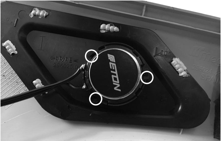
Entfernen Sie mit einem scharfen Messer die drei Schmelzpunkte der Hochtönerfestigung. Entfernen Sie das Schutzpapier des beigefügten Kleberings und setzen diesen auf den neuen Hochtöner. Ziehen Sie anschließend das Schutzpapier des Kleberings ab und stecken den Hochtönerlautsprecher auf die Stifte der Lautsprecheröffnung. Achten Sie darauf, dass alle Klipse ordentlich eingerastet sind und der Klebering ordnungsgemäß abdichtet.
