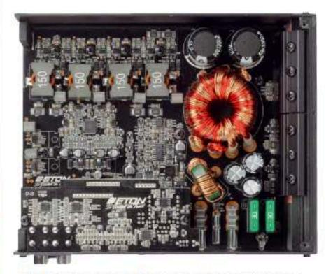
Die Mini ist recht vollgepackt, die Leistungstransistoren der Verstärkung sitzen unter der Platine
