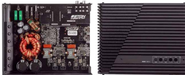
Moderner Verstärkerbau mit individuellem Layout und prima Bauteilen. Neben den Class-D-ICs gibt es jedoch auch Leistungstransistoren unter der Platine
